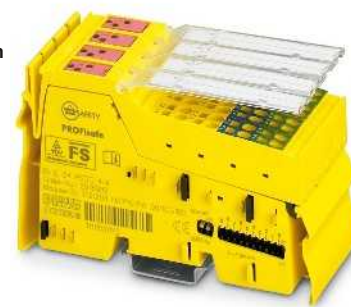
Módulo de salida digital, conmutable +/-
