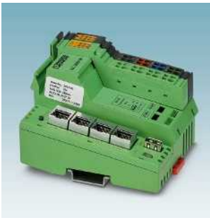
PLC para la infraestructura de edificios Pág. 47
