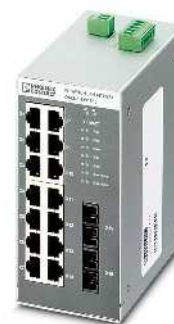
14 puertos RJ45 y 2 puertos de fibra óptica
