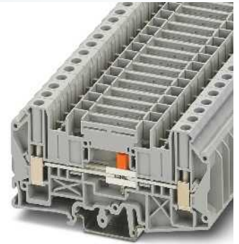
50 A, borna seccionable para transductores de medición, 4 fosos de puente enchufables, 2 fosos de puente atornillables
