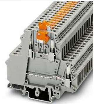
4(4) mm 2 , 26 A, borna de doble piso interrumpible por cuchilla con hembra roscada para tomas de prueba
