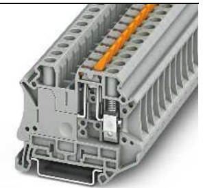
20 A, borna interrumpible por cuchilla, con palanca de accionamiento, hembras roscadas para tomas de prueba
