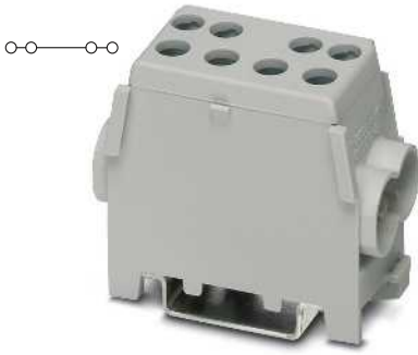
25 (35) mm 2 , 125 A, módulo de ramificación de cable principal, 2 salidas de 25 mm 2
