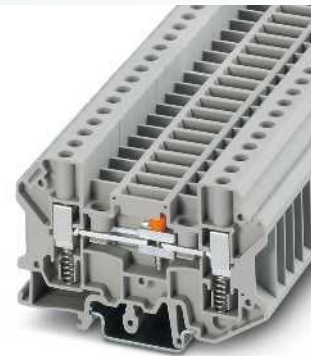
6 (10) mm 2 , 57 A, borna interrumpible para transformador de medida
