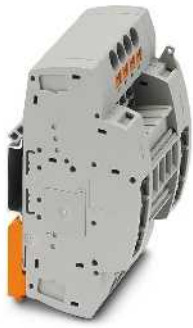
Regletero de clavijas de prueba 6 (10) mm 2 , 30 A, 4 ... 25 polos, para montaje sobre carril, conexión push-in
