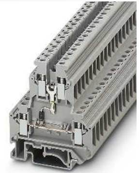
4 (4) mm 2 , 32 A, borna de doble piso de diodo
