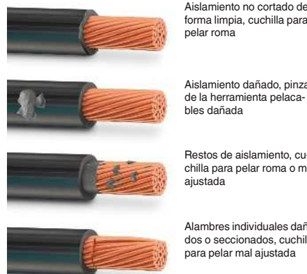
Fallo de aislamiento según DIN IEC 60352-2
