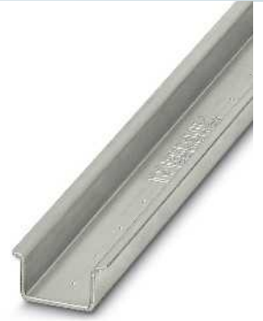
Acero, galvanizado y pasivado de capa gruesa, grosor de material 2,3 mm
