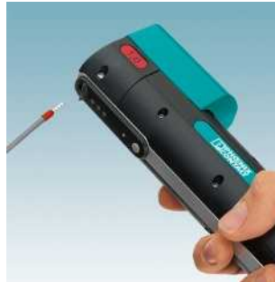
Engarzador automático portátil, para pelar y engarzar en una operación CRIMPHANDY Pág. 440
