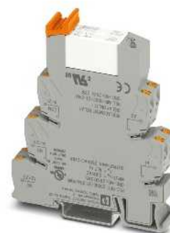
Módulo de relés de 2 contactos conmutados para 16,7 Hz de frecuencia de entrada, máx. 2 x 6 A
