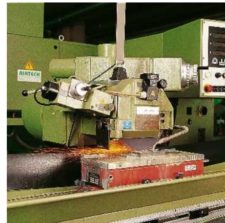
Protección contra bloqueo y rotura de herramientas, umbral de advertencia antes del desgaste de la herramienta y del cojinete.
