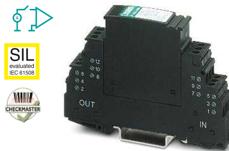
4 conductores con potencial de referencia conjunto, conexión 9/10 mediante descargador de gas puesto a tierra, p. ej. para señales binarias
